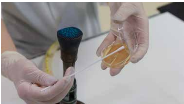
Figura 15. Repique de amostra coletada em swab para placa com meio de cultura realizado em laboratório
