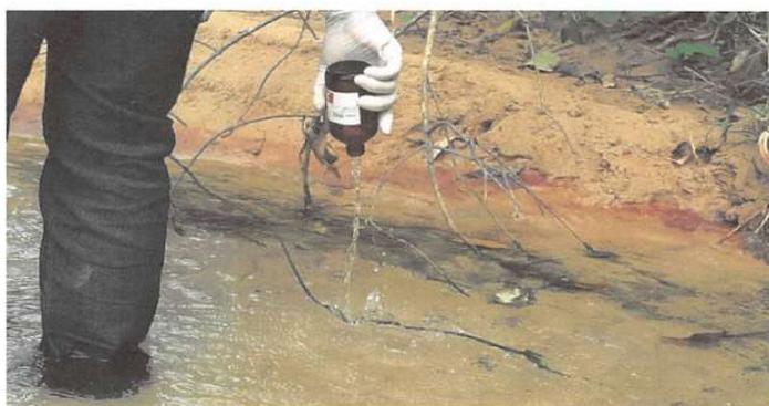
Imagem 4 – Coleta da AMOSTRA 1 - Córrego Central a montante do emissário – Triplíce lavagem do frasco âmbar.
